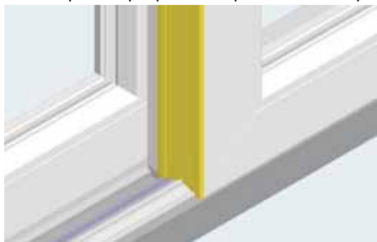
маскирующий профиль (105.333), предварительное перфорирование снизу (вид со стороны помещения)
