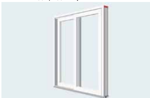
маскирующий профиль (105.333), предварительное перфорирование снизу (вид со стороны помещения)
