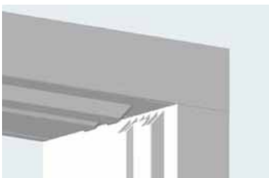
дистанционный профиль (105.331) установлен на зажим в коробке сверху
