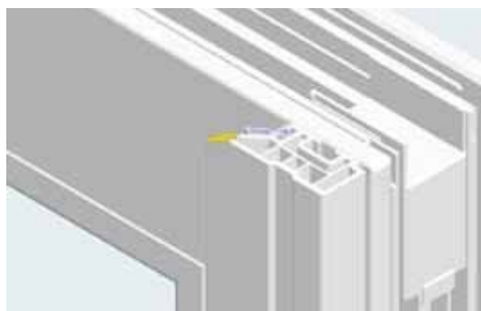
планка под среднее уплотнение со скосом на верхней поверхности
