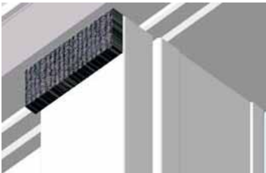
уплотнение (106.295) на планке под среднее уплотнение (105.335)
