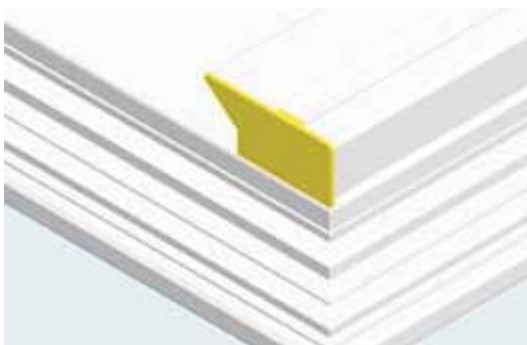
приклеивается к нижней стороне планки под среднее уплотнение
